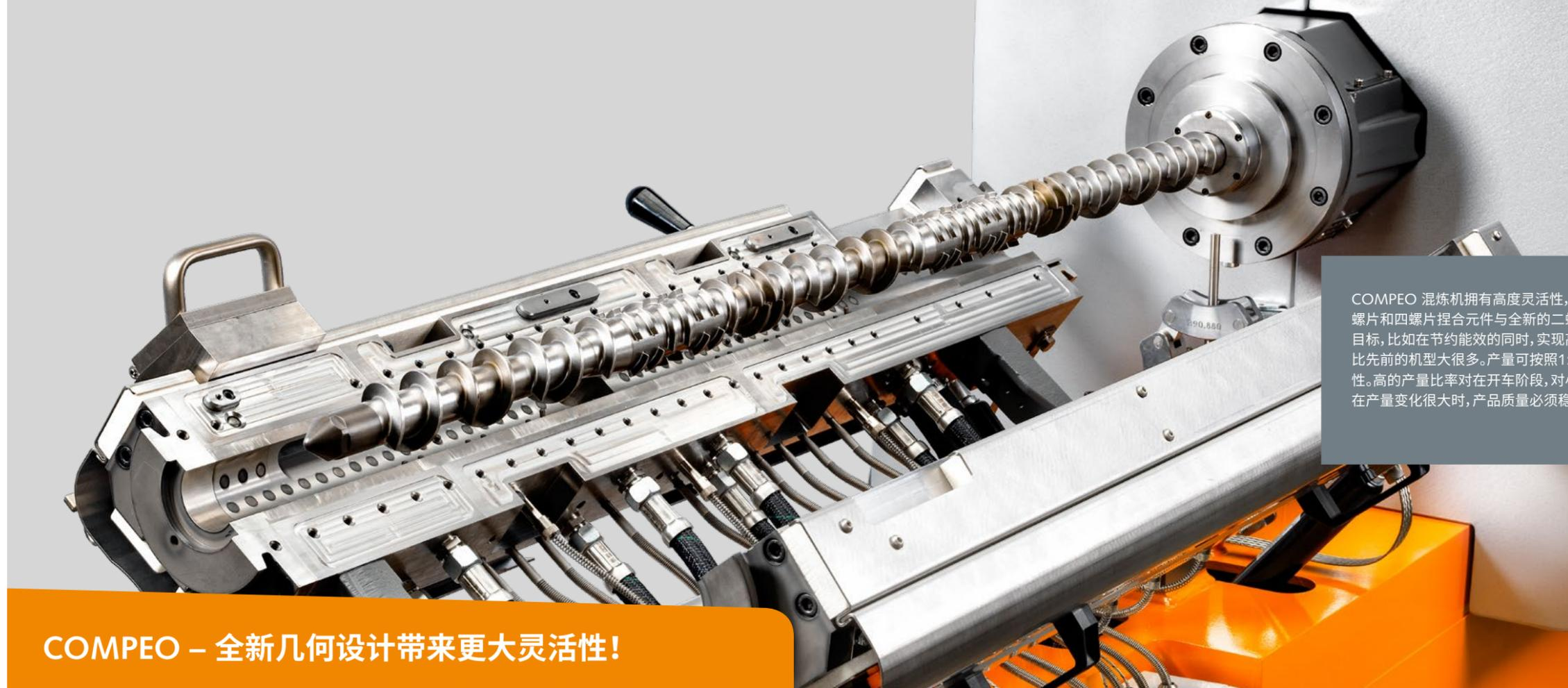
COMPEO 混炼机拥有高度灵活性,因为它可在工艺段的任何所需工位将传统的三螺片和四螺片捏合元件与全新的二螺片或六螺片相结合。因此,可实现之前冲突的目标,比如在节约能效的同时,实现高产量。另外,COMPEO 系列的工艺加工窗口比先前的机型大很多。产量可按照1:6的比率变化,以提高系统灵活性和用户友好性。高的产量比率对在开车阶段,对小批量和在线加工特别有利,下游单元要求即使在产量变化很大时,产品质量必须稳定。
