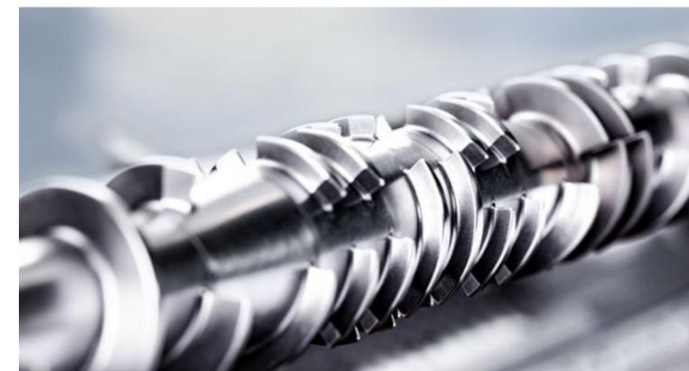
用于电缆料生产的新型熔融螺纹元件取代原先装于混炼机机筒上的限流环
